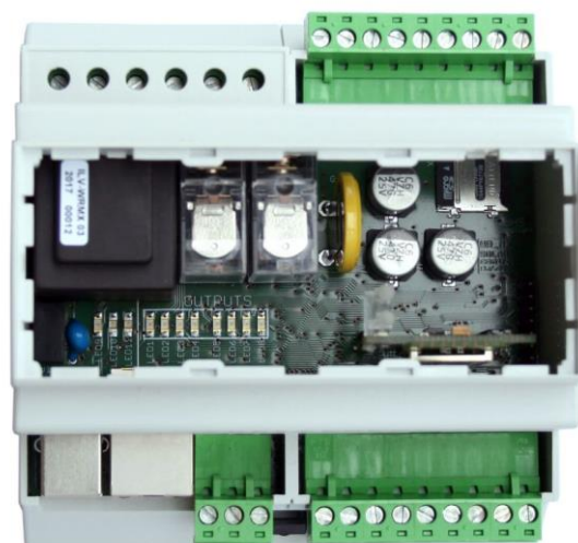
Obrázek 14: Výsledná pozice modulu uvnitř regulátoru.
